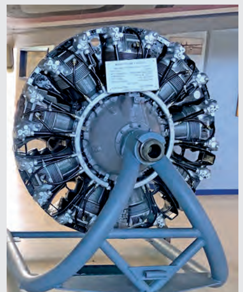
Flysamlingen på Gardermoen, en 9 sylindret stjernemotor som har vært brukt i norske flybåter under 2. verdenskrig.
